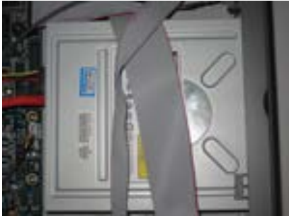
Рис.1.2.1. Подключение кабелей к CD/DVD
